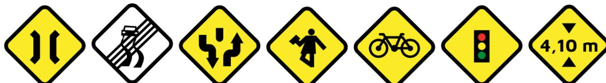
Puente estrecho Fin calzada resbaladiza Principio y fin de calzada dividida Escolares Ciclistas Proximidad de semáforos Altura limitada
